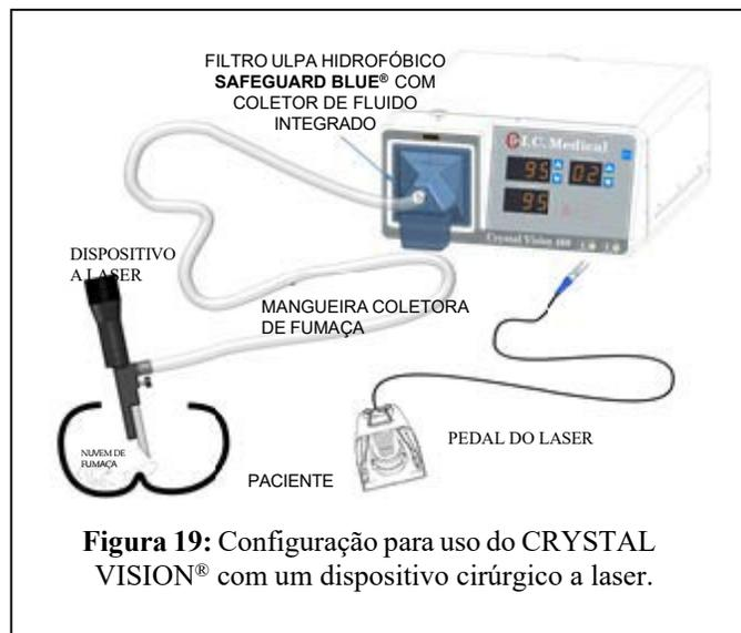
**Figura 19:** Configuração para uso do **CRYSTAL VISION**® com um dispositivo cirúrgico a laser.
